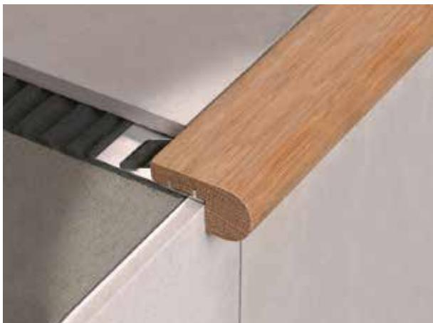
STAIRTEC FW è un paragradino in legno naturale supportato da una struttura angolare in alluminio traforato che assicura l'incollaggio e la stabilità dell'insieme. La sua forma elementare e le sue dimensioni lo rendono utilizzabile in ogni tipo di ambiente, sia moderno che tradizionale. Ideale per applicazioni di scale domestiche, ma può essere impiegato anche per completare piani cucina piastrellati.
